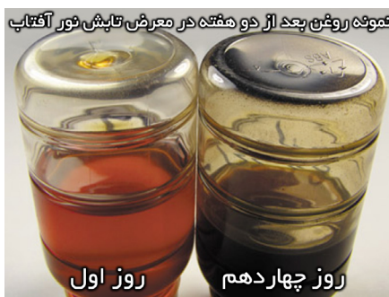
تصویر (1-17) فاسد شدن روغن در اثر تابش آفتاب به ظرف نمونه‌گیری.
