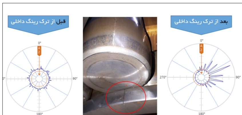
شکل ۴-۱ سیگنال حوزه زمان به صورت دیاگرام دورانی
