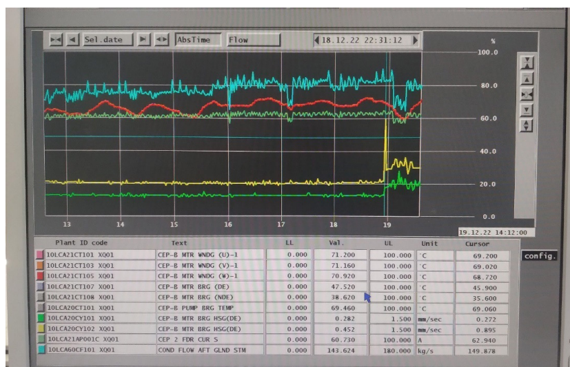
شکل ۱۰- ترند ویبره یاتاقان پمپ اکسترکشن
