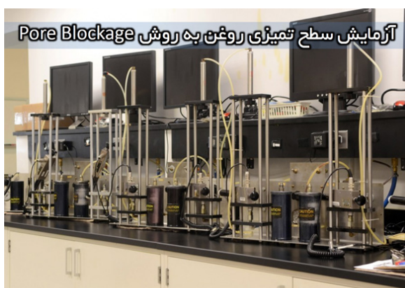
تصویر (۹-۱۱) - آزمون انسداد منفذ (Pore Blockage)
