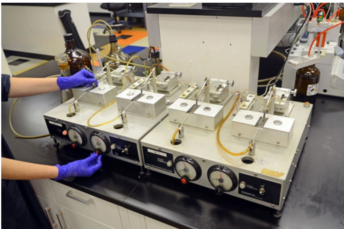
تصویر (۲۰-۹) - روش انجام فروگرافی مشاهداتی (AF) Analytical Ferrography
