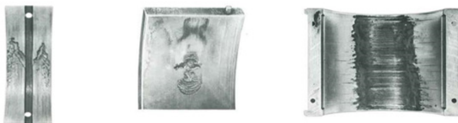
تصویر (۸-۳) - خستگی تماسی بابیت یاتاقان به دلیل حضور آب در روغن توربین
